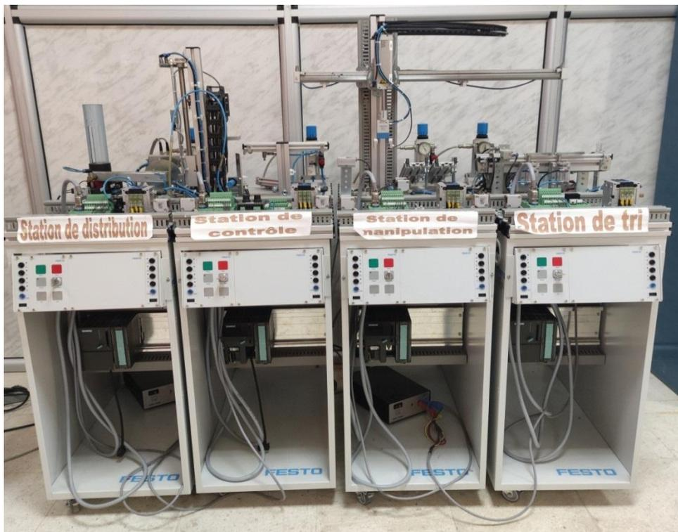
**Figure IV.1 :** Exemple de quatre stations du système MPS
