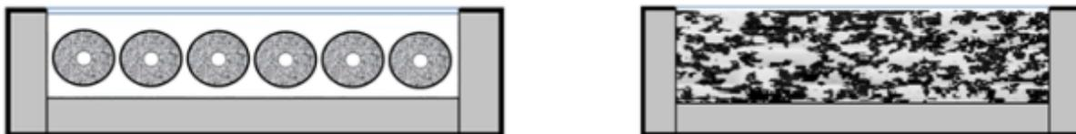
**Figure II.7 :** Lit d'adsorption tubulaire et rectangulaire
