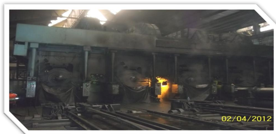
Figure II. 4: Photo des cinq cages du tandem.
