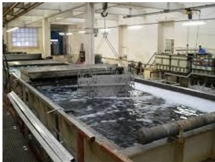
Figure II. 6: Une ligne de dégraissage.
