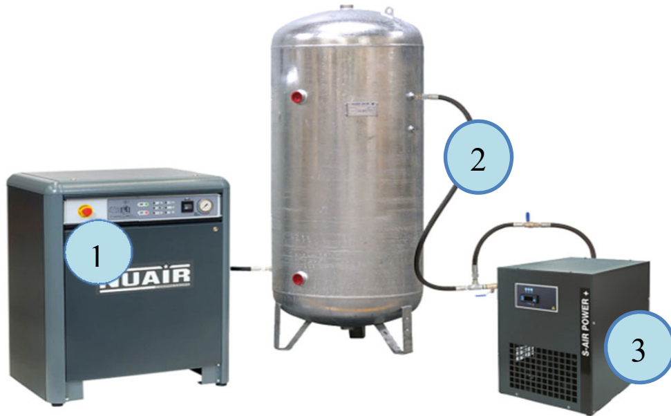
Figure II.1 : Les composants principaux d'une unité de traitement d'air comprimé.
