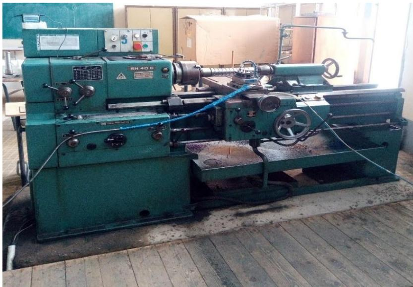
**Figure II.1** Tour à charioter et à fileter modèle SN40
