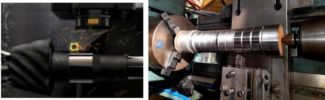
**Figure I.9** Opération de chariotage du tournage dur (Sandvik Coromant). [4]
