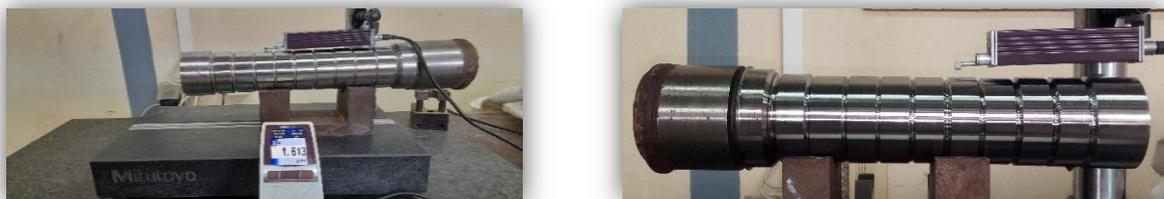
**Figure II.7** Rugosimètre (SurfTest\_SJ-210 Mitutoyo).
