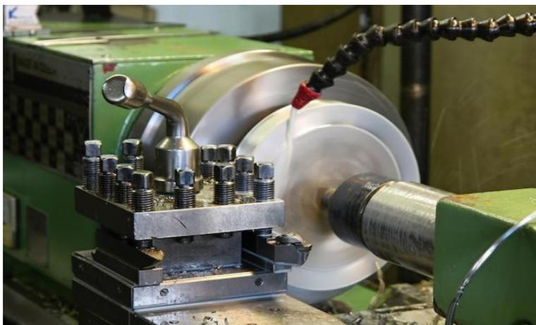
**Figure I.16** lubrification abondante.
