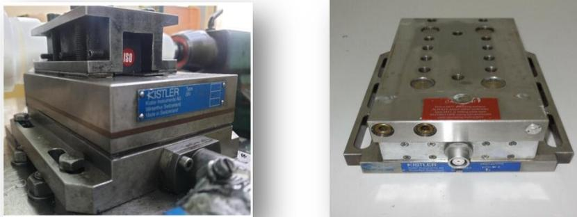
**Figure II.8** Dynamomètre (KISTLER9257 B)
