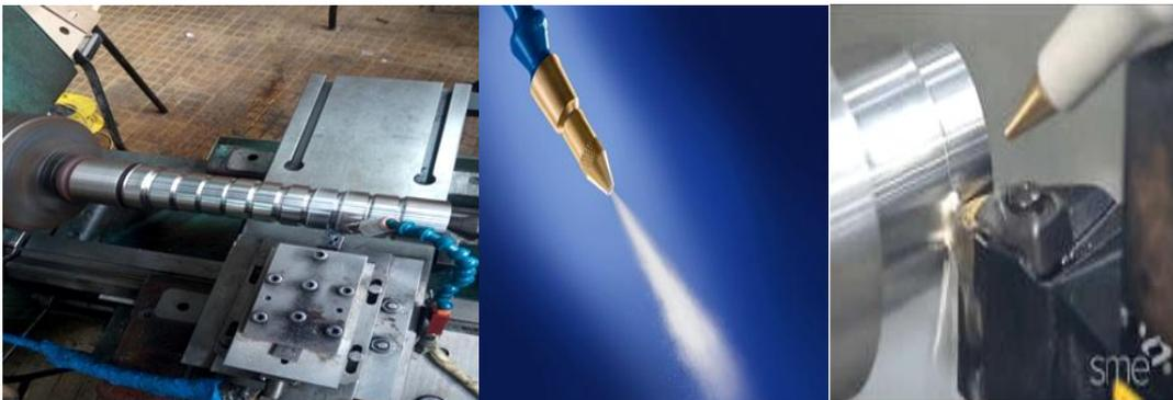
**Figure I.15** Système MQL-minimum-quantité-lubrifiants mélange air/huile [12]
