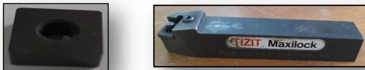
**Figure II.6** Plaquette et porte plaquette utilisés
