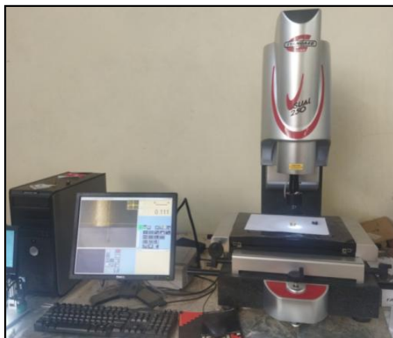
Figure II.10. Microscope pour la mesure de l'usure VB (Visuel Gage 250)
