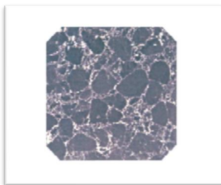
Figure I.9. Microstructure du nitrure de bore cubique (CBN) [11].
