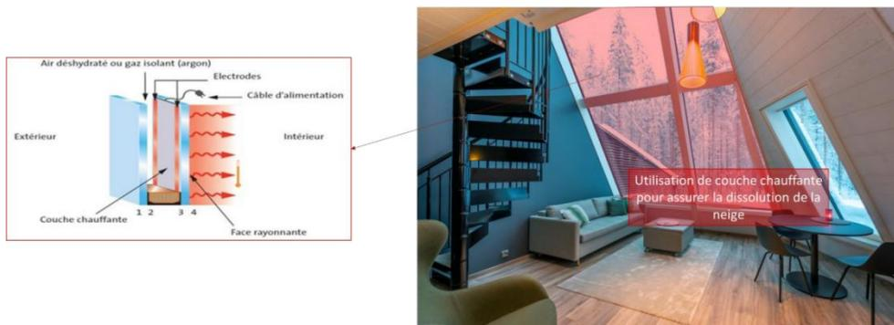
Figure N°104: Couche chauffante dans le vitrage.
