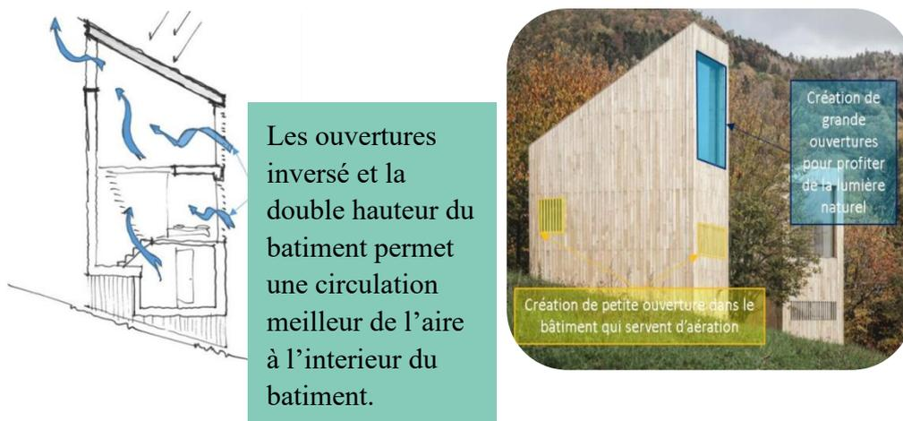
Figure N°88: Aération et ouverture dans le chalet Tree.
