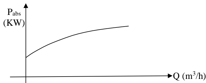
Fig.3.7: Courbe caractéristique pratique P_{\text{absolue}} en f(Q)
