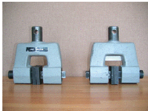
Figure 2.2 : Photo des Mors utilisés lors de l'essai de traction.
