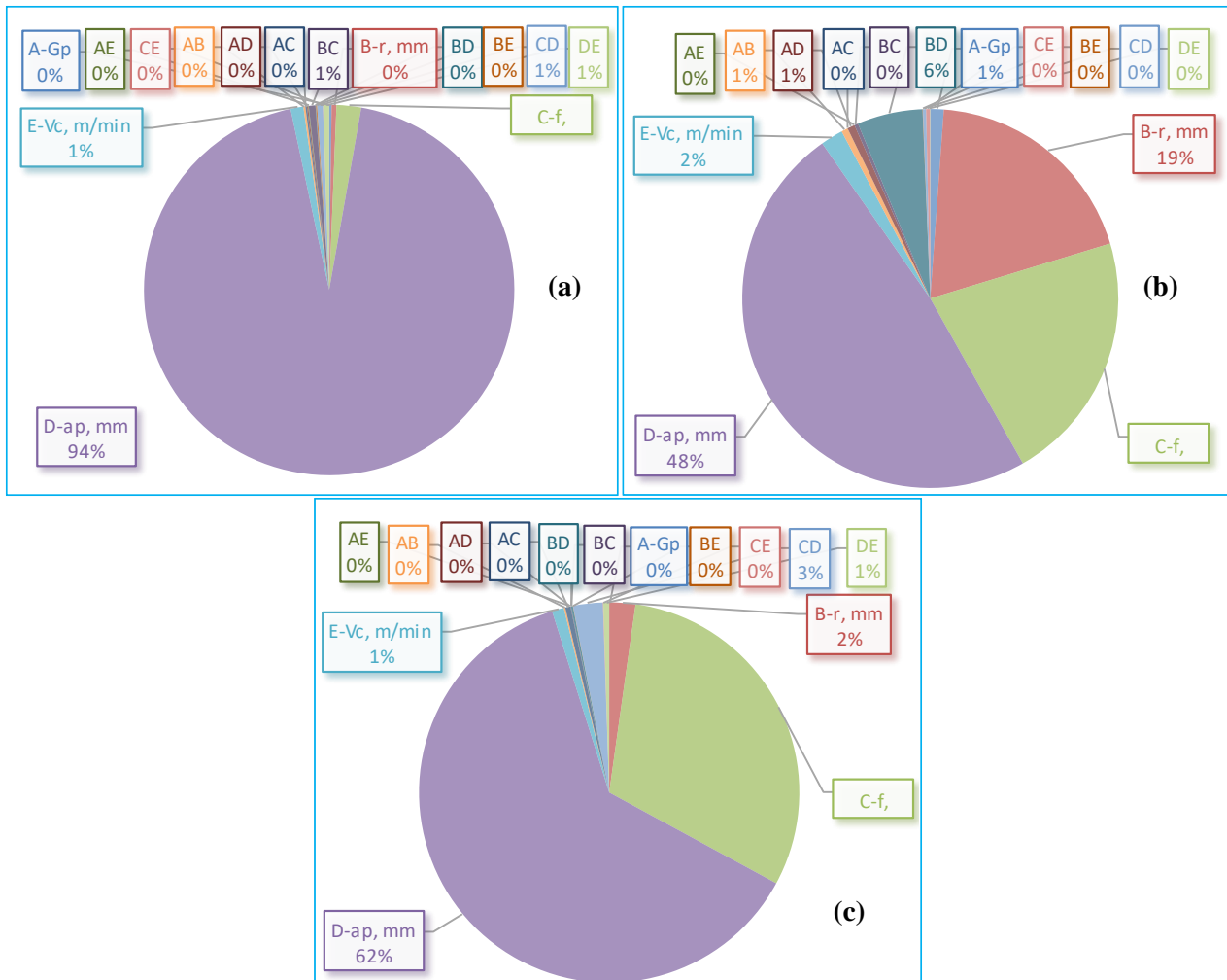
Figure IV. 11 : Diagramme circulaire des effets des paramètres de coupe sur la rugosité (a) Fx, (b) Fy et (c) Fz
