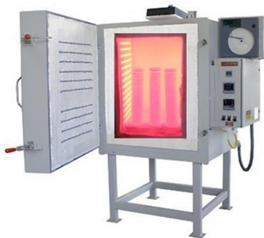
Figure II.6: Four à chambre électrique pour le traitement thermique des éprouvettes.
