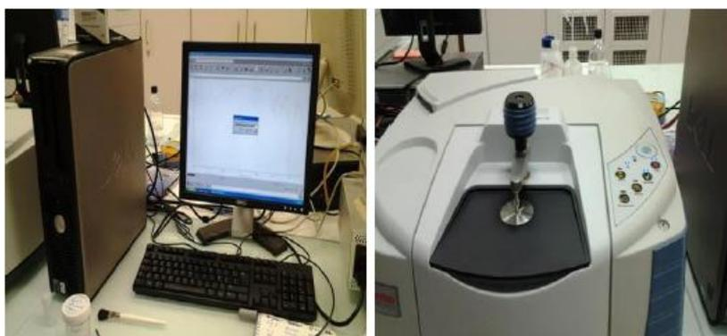
**Figure II.11:** Spectromètre Nicolet iS50 (Thermo Fisher Scientific Inc., Waltham, MA, USA)
