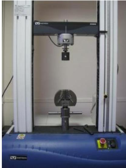
**Figure II.17 :** Système d'essai électromécanique universel (UTS) INSTRON 3366
