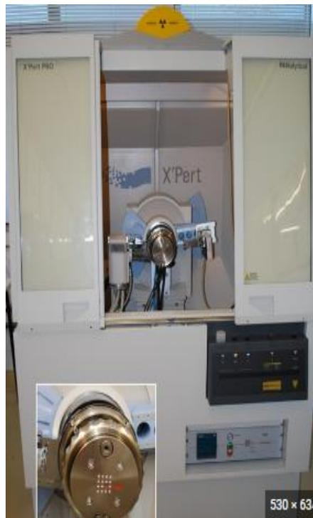
**Figure II.12** : Diffractomètre Panalytical X'Pert PRO (Panalytical, Almelo)
