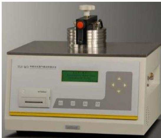
**Figure II.19** : Analyseur de perméabilité MultiPerm (Extra Solution produit par PermTech, S.r.l., Pieve Fosciana (LU), Italie)
