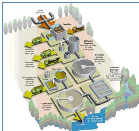
*Fig.1.2. Principe de fonctionnement des stations d'épuration des eaux usées.*
