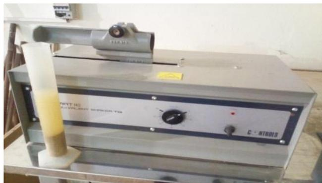
**Fig. 3.3. Appareillage de l'essai équivalent de sable**
