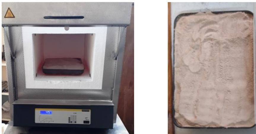
Fig. 3.8.. Calcination thermique du kaolin (Metakaolin)
