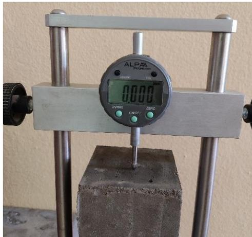
*Fig. 4.11. Essai de Retrait total*
