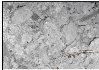
**Fig. 2.4. Béton dégradé par formation de thaumasite (perte totale de cohésion et mise à nu de l'armature)**
