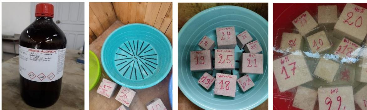
Fig.4. 3. Essai d'attaque à l'acide sulfurique
