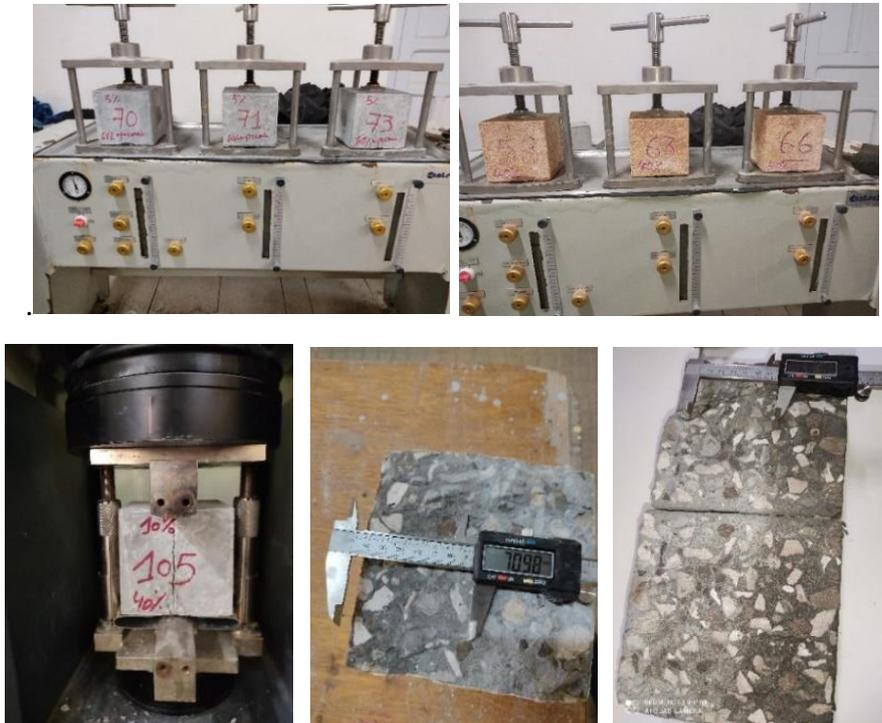
Fig.4.7 Essai de pénétration de l'eau dans le béton avant et après exposition à l'acide
