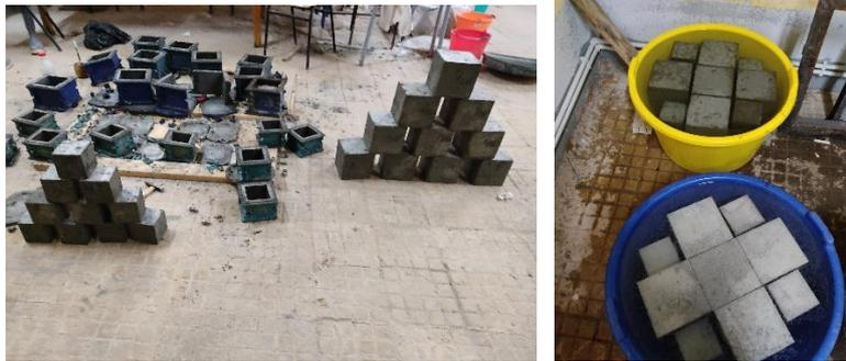
*Fig. 3.15. Démoulage et conservation des éprouvettes de béton*
