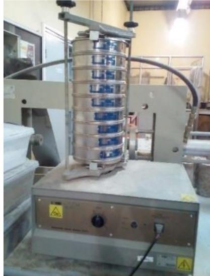
Fig. 3.1. Essai de granulométrie par tamisage
