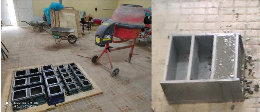
*Fig. 3.12. Photos des moules utilisés pour la confection des éprouvettes*
