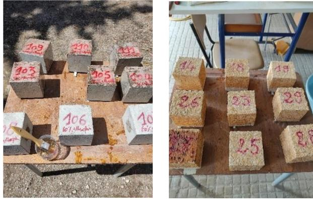
*Fig. 4. 8. Imperméabilisation des éprouvettes avant et après exposition à l'acide*
