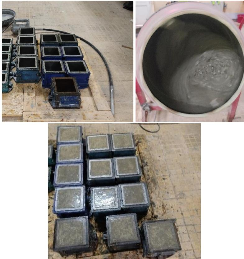
*Fig. 3.14. Photos du coulage du béton*
