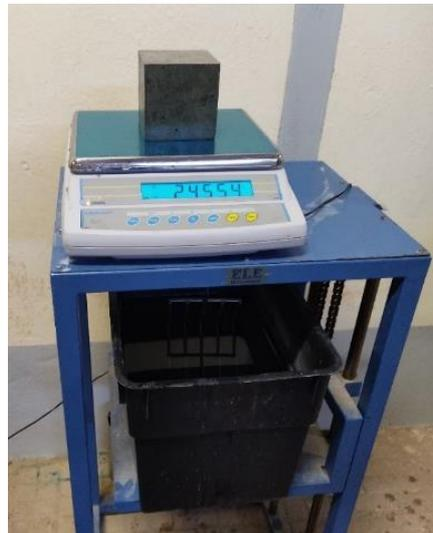
Fig. 4.6. Mesure de la Porosité accessible à l'eau
