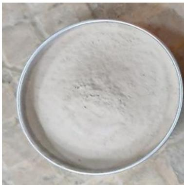
Fig. 3.7. Laitier granulé de haut fourneau broyé (GBFS)
