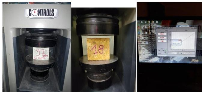
Fig. 4.5. Mesure de la résistance à la compression avant et attaque d'acide
