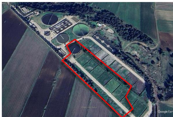
**Fig. 1. 14. Lits de séchage des boues**
