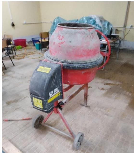
*Fig.3.13 la bétonnière utilisée*
