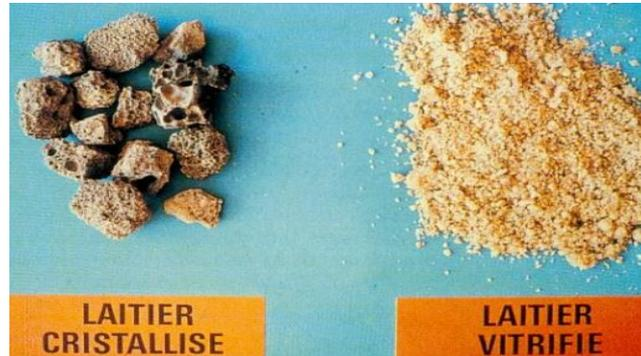
Fig. 2. 8 Laitier de haut fourneau (Rocheux et Granulé)
