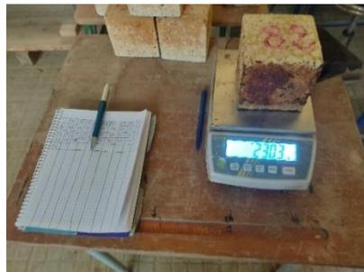
*Fig. 4.10. Mesure du poids des éprouvettes avant et après exposition à l'acide*
