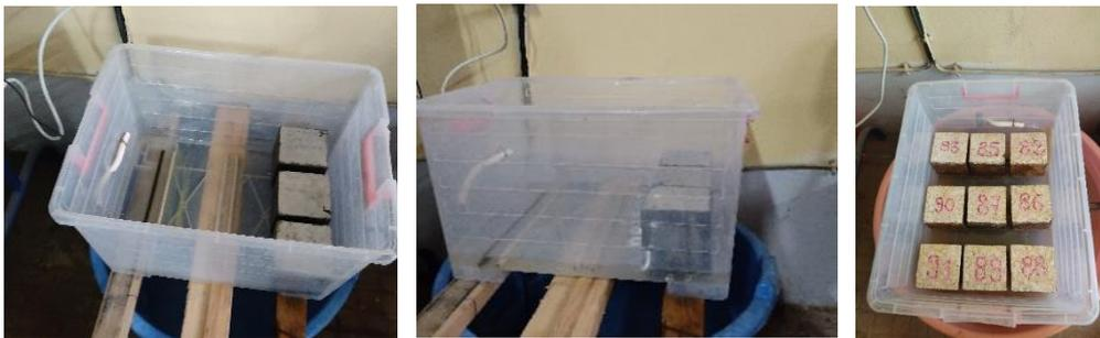
*Fig. 4.9. Essai d'absorption d'eau par capillarité avant et après exposition à l'acide*
