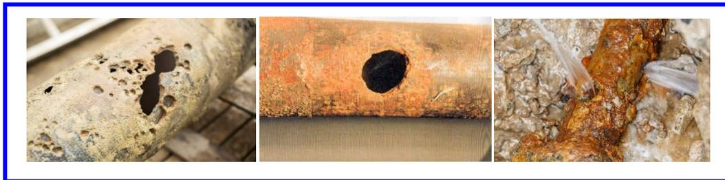
**Figure 1.12 : Conduites ayant subi une corrosion externe localisée**
