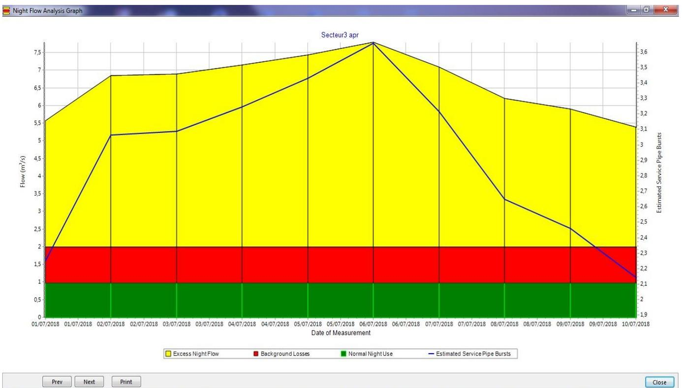
**Figure 5.13: Fuite, pertes de fond et utilisation nocturne dans le secteur 3 avant et après modulation Source : (SanFlow v4.6)**
