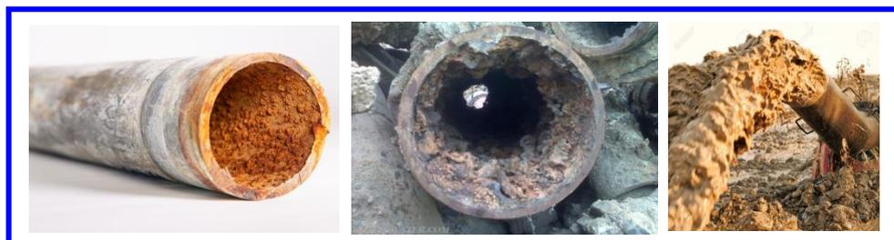
**Figure 1.11 : Conduites ayant subi des dépôts ferriques de corrosion interne**
