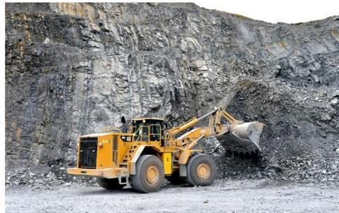
Figure II.1. Extraction des roches pour granulats de carrière.
