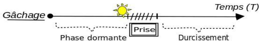
Figure III.4. Schéma présentant le début et fin de prise du ciment.
