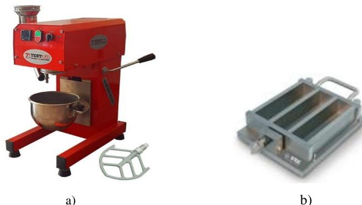
Figure IV.8. Malaxeur normalisé (a) et moule normalisé (b) pour pate et mortier normal.
