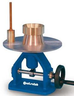
Figure IV.5. Table à secousses manuelle.
