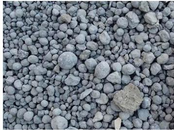
**Figure II.8.** *Laitier granulé de haut fourneau*
