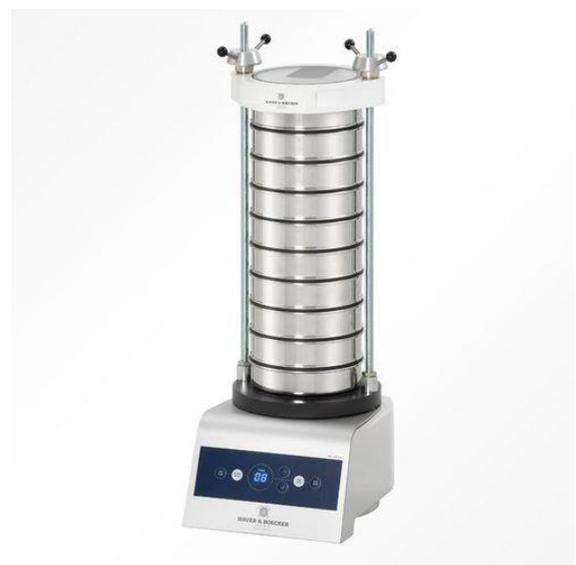
**Figure II.10.** Série de tamis avec une tamiseuse électronique.
