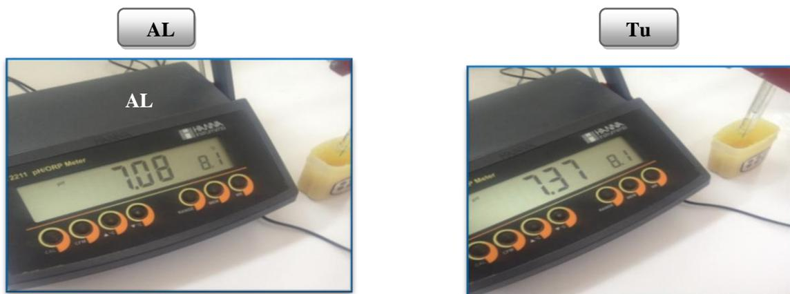
**Figure 43 : Mesure du pH des pommades antiseptiques**
