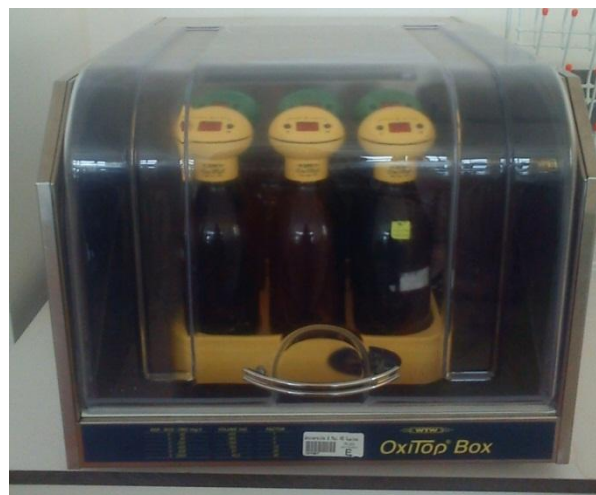
Figure 26 : Photos d'un DBOmètre de type WTW OxiTop Box.
