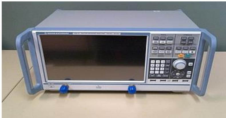
Figure (III.4) : L'analyseur de réseau "R&S ®ZNB20".
