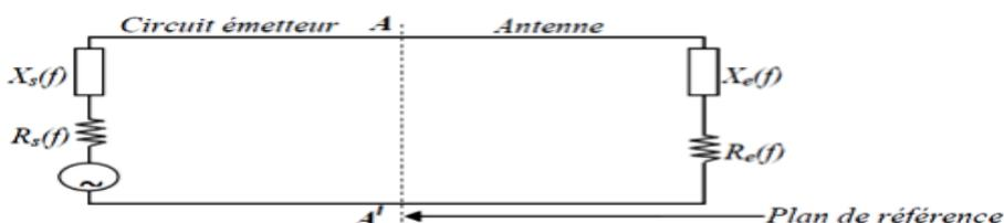
Figure (I.2) : Le Schéma équivalent du dispositif à l'émission [7].
