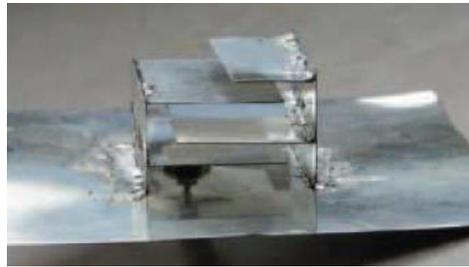
**Figure I.7.** PIFA replie sur plusieurs niveaux
