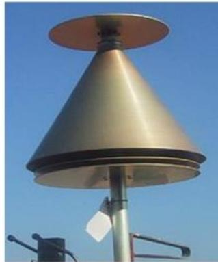
**Figure II.17.** Antenne discône.
