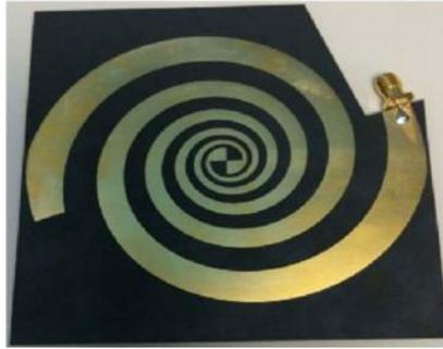
**Figure II.12.** Antenne spirale d'Archimède à deux brins
