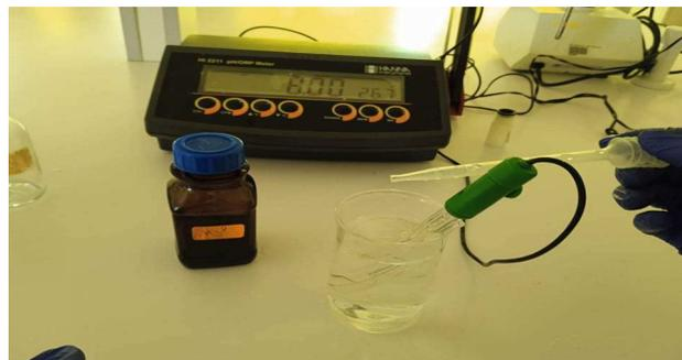
**Figure 15 :** Ajustement du Ph par HCL
