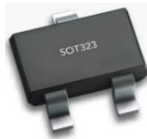
Figure II.11 : Puce RFID en packaging standard de type SOT23.
