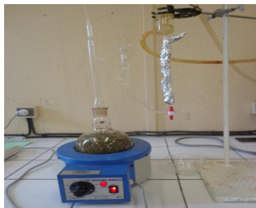
Figure 19 : Appareil d'extraction des huiles essentielles par hydrodistillation de type Likens Nickerson
