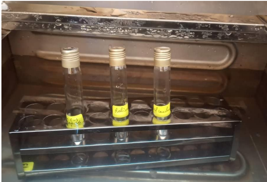
Figure 12 : Photographie de l'hydrolyse des racines dans l'HCL de 1N à 60° C dans le bain marie.
