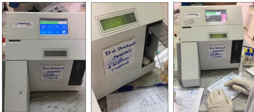
Figure 14 : Etapes du dosage des ions \text{Na}^+ et \text{K}^+ par l'analyseur Smartlyte ® Plus
