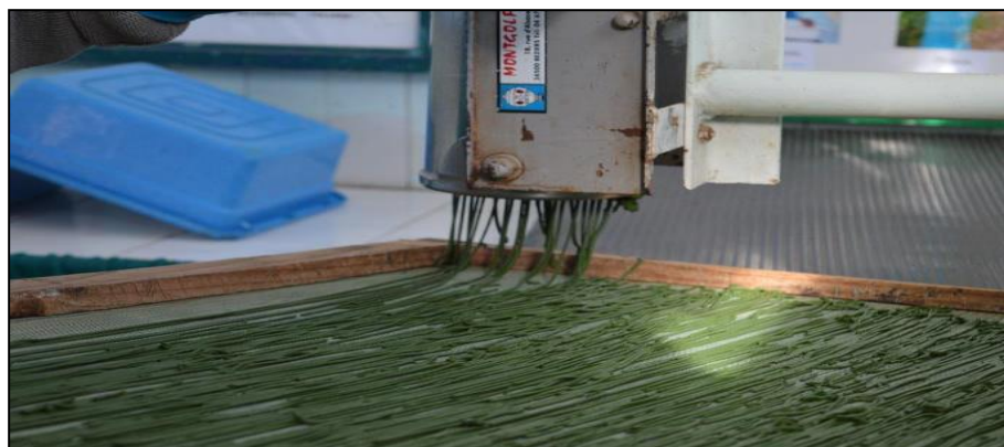
Figure 23 : Biomasse transformée sous forme de spaghettis par l'extrudeuse (Goulamabasse, 2018)
