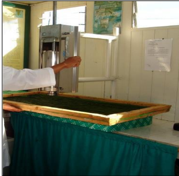
Figure 22: Extrudeuse de capacité d'environ 5 kg de biomasse (Goulamabasse, 2018)
