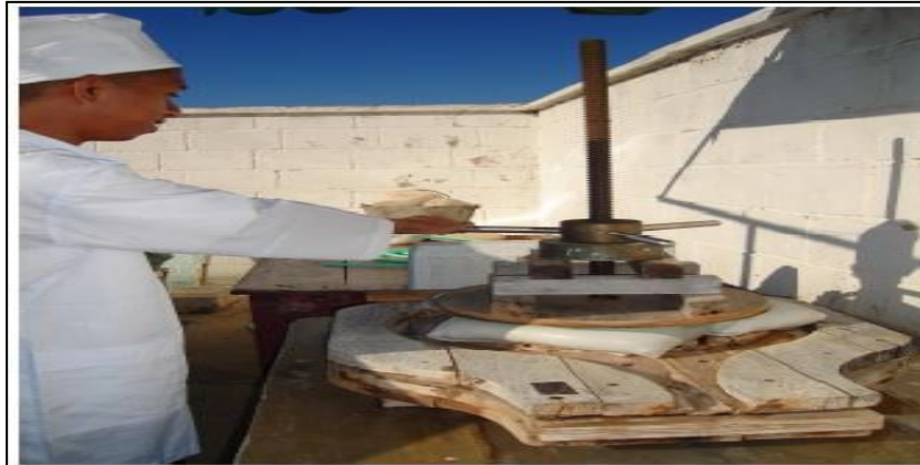
Figure 20 : Pressage par une presse à vis ( Goulamabasse, 2018 )
