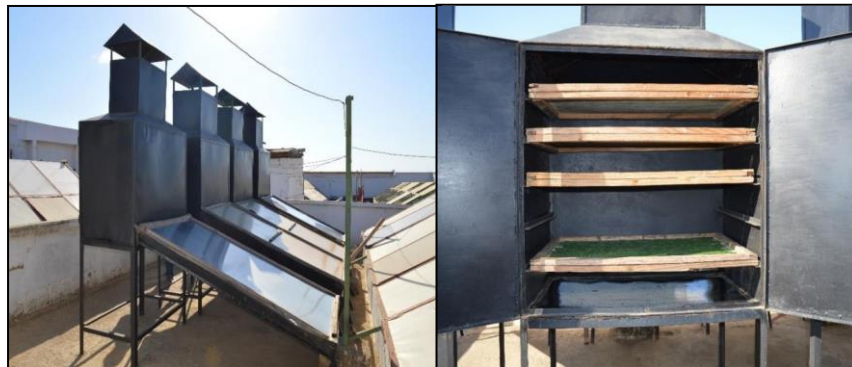
Figure 24 : Séchage de la spiruline dans un séchoir solaire ( Goulamabasse, 2018 )
