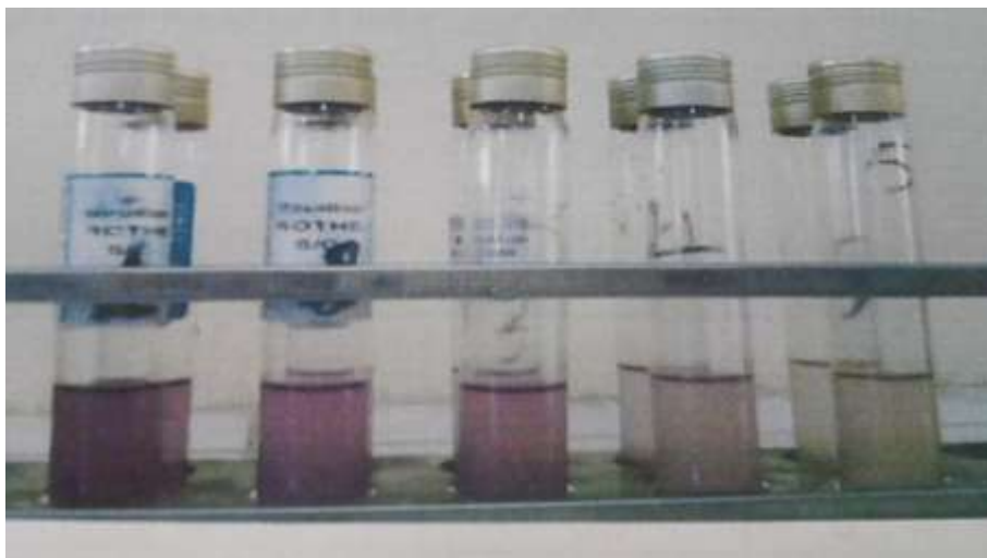
Photo 7: Gamme d'étalonnage d'acide oléique (dilutions croissantes, de couleurs variables) utilisée pour le dosage des protéines totales dans les différents échantillons.
