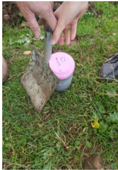
Figure04 : échantillon de sol prélevé par le cylindre de Burger
