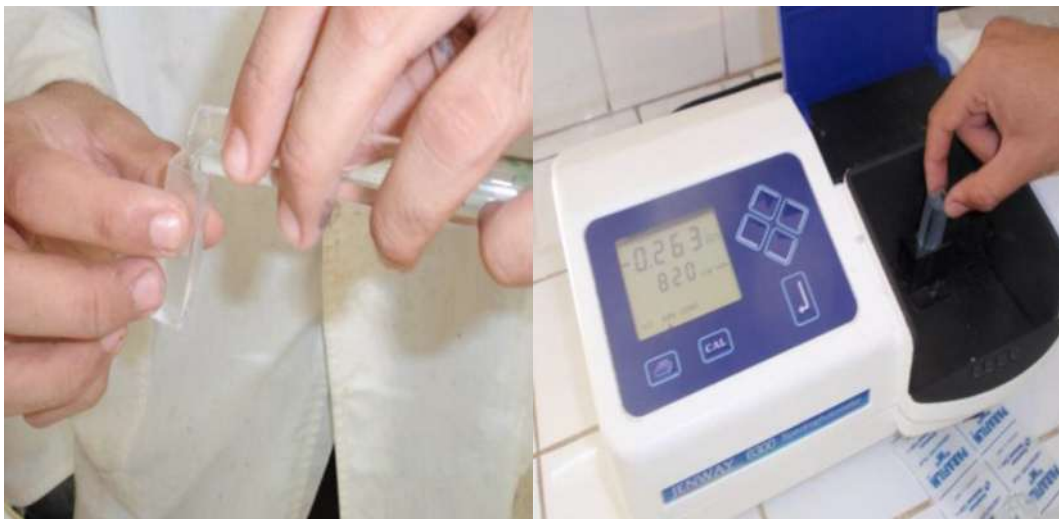
Figure 17: le spectromètre a flamme On lit l'intensité de la couleur à une longueur d'onde de la gamme et des échantillons à 820nm après 15 à 30mn.
