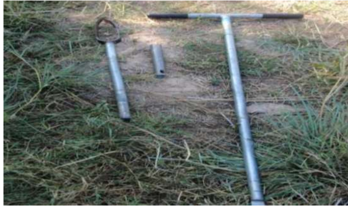
Figure 2: Outil de prélèvement des échantillons de sol-Tarière
