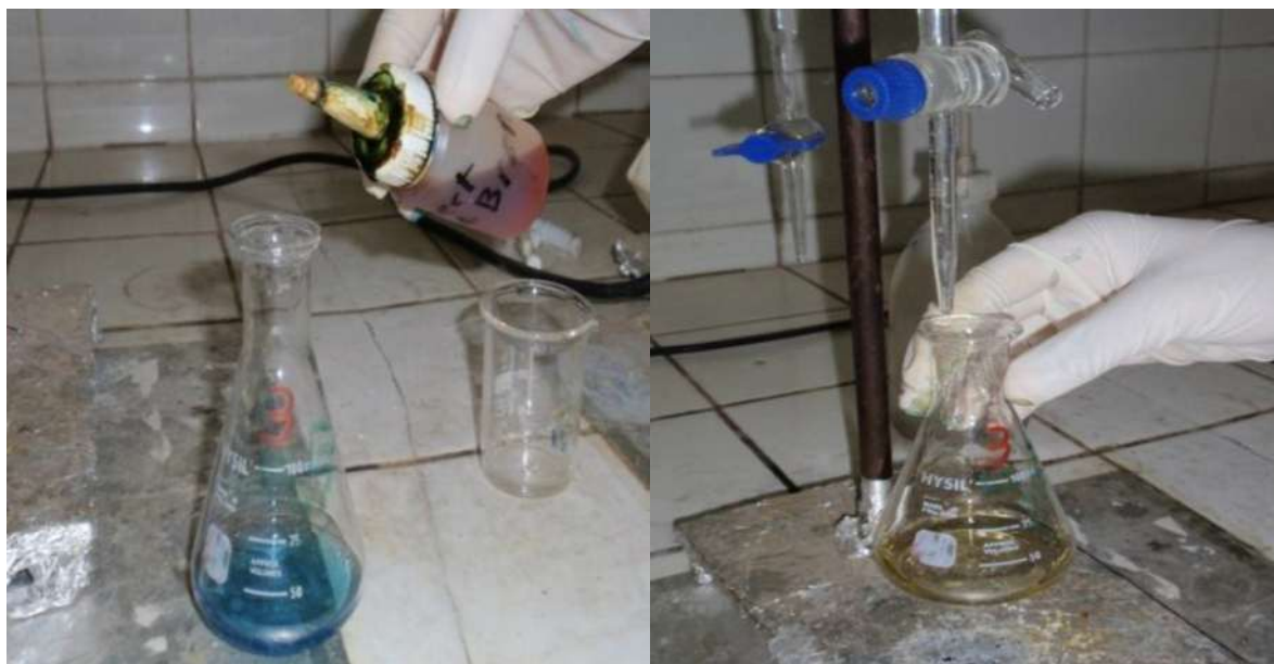
Figure23: l'ajout de l'indicateur coloré (Bromocrésol
