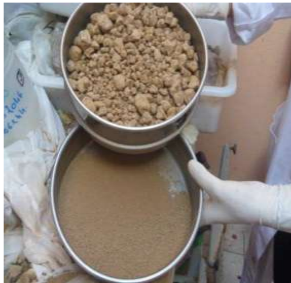
Figure 7: broyage et tamisage des échantillons de sol à 2 mm
