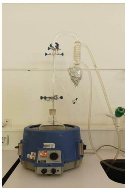
Figure 07: Photographie du montage de type Clevenger utilisé pour l'extraction des huiles essentielles (Photo personnelle)
