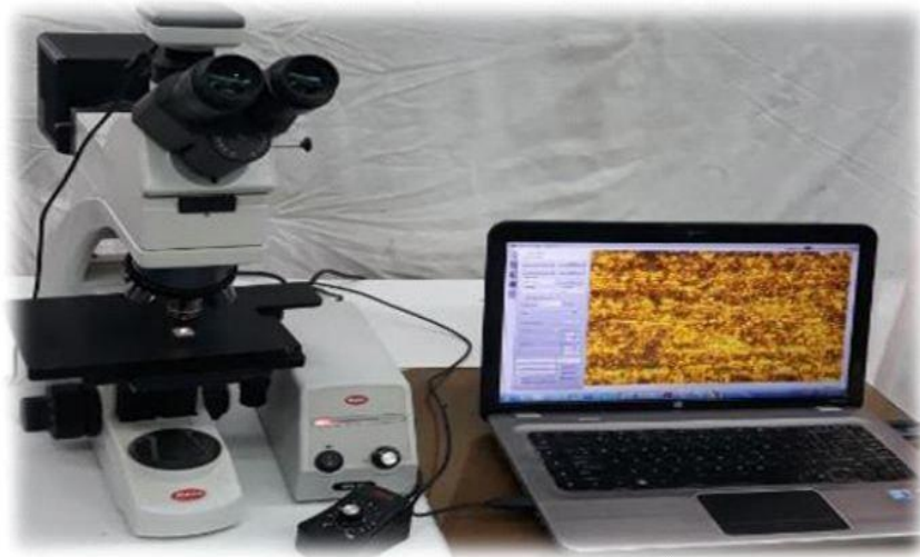
Figure III. 4 : Microscope optique de type ZEISS.
