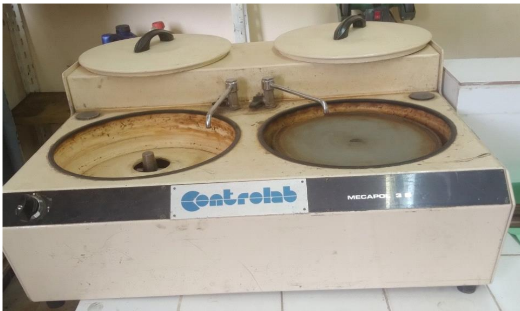
Figure III.2 : Polisseuse mécanique de type MECAPOL 3B.
