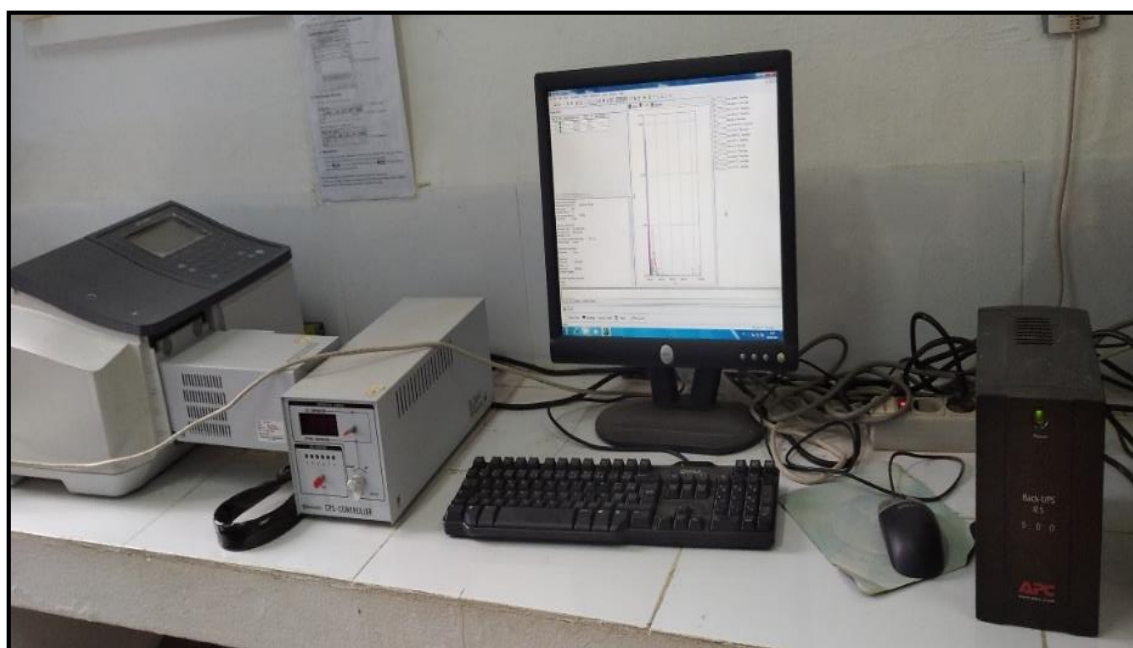
Figure 4.12 : Spectrophotomètre UV-Visible à double faisceau Shimadzu model UV 1800.
