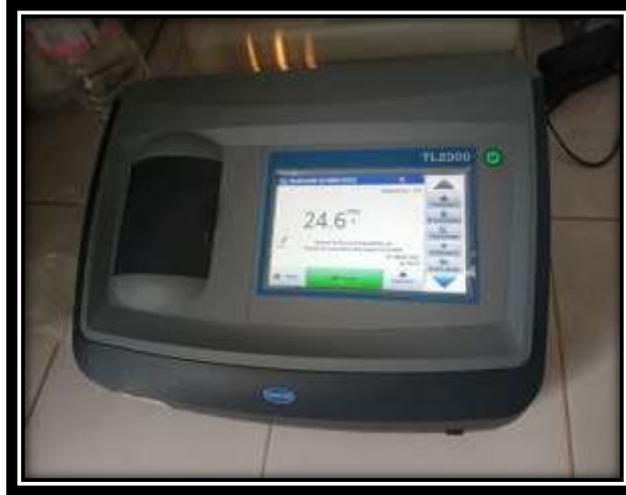
**Figure29** : Image de turbidimètre utilisé dans le laboratoire
