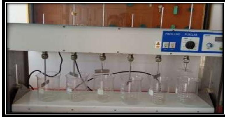
Figure42 : Dispositif expérimental de l'essai jar-test
