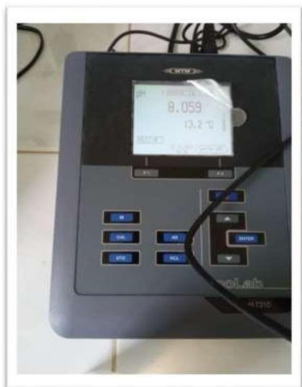
**Figure28** : Image d'un PH-mètre
