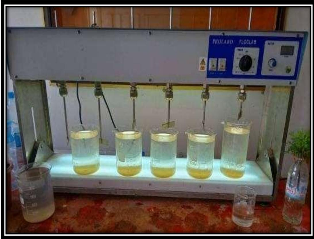
**Figure 27 :** Dispositif expérimental de l'essai jar-test après l'opération
