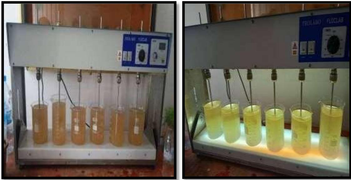
**Figure 26 :** Dispositif expérimental de l'essai **Jar-test** avant l'opération
