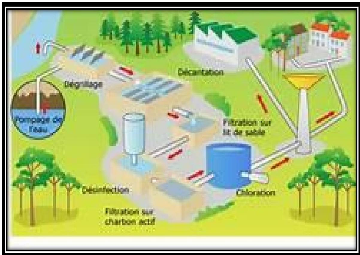
Figure 13 : Chaîne de traitement de l'eau.
