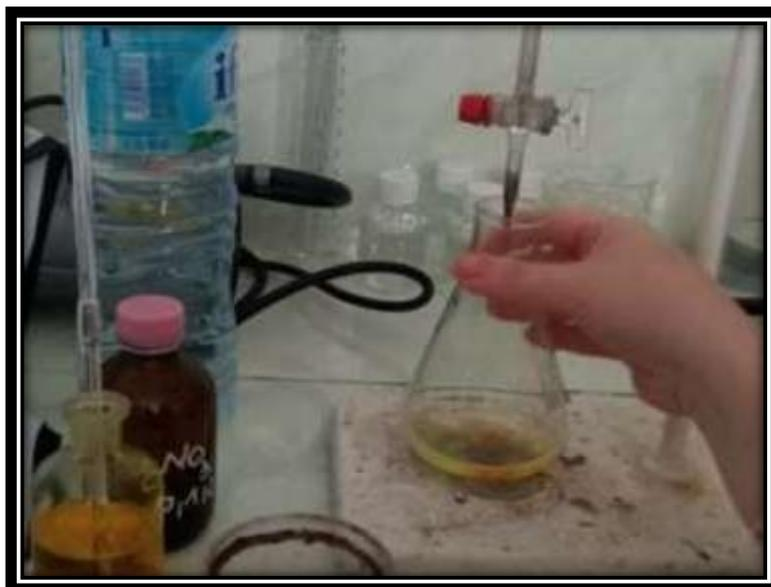
Figure33 : Montage représentant l'analyse de  $\text{Cl}^-$
