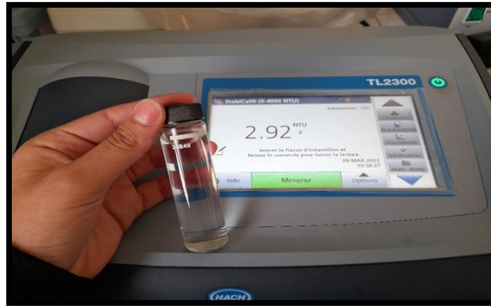
Figure 13: Mesure de la turbidité (Turbidimètre de type HACH 2100) .
