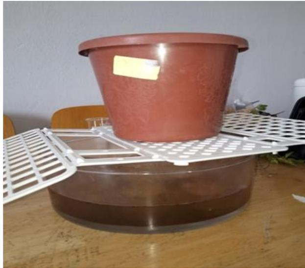
**Figure 19** : Détermination de la capacité au champ (photo personnelle).
