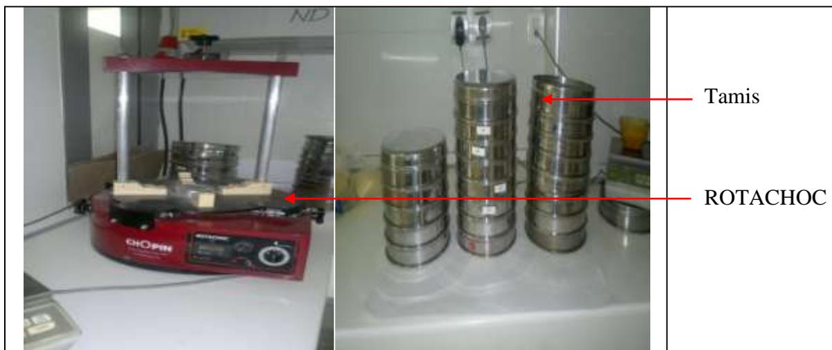
**Figure 07:** Matériel utilisé pour la détermination de granulation
