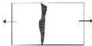
Corrosion sous contrainte
