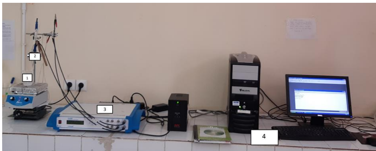
Figure 3. 1 : Dispositif expérimental utilisé pour l'élaboration des couches minces DLC et Ni/DLC
