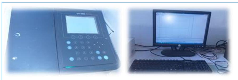
**Figure V-5 :** Spectrophotomètre UV-Visible Shimadzu model (RF-5301 PC).
