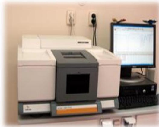
Spectrophotomètre a transformée de fourrier (FT-IR).
