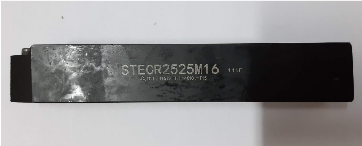
Figure II.3 : Porte plaquette utilisée dans les opérations de tournage.
