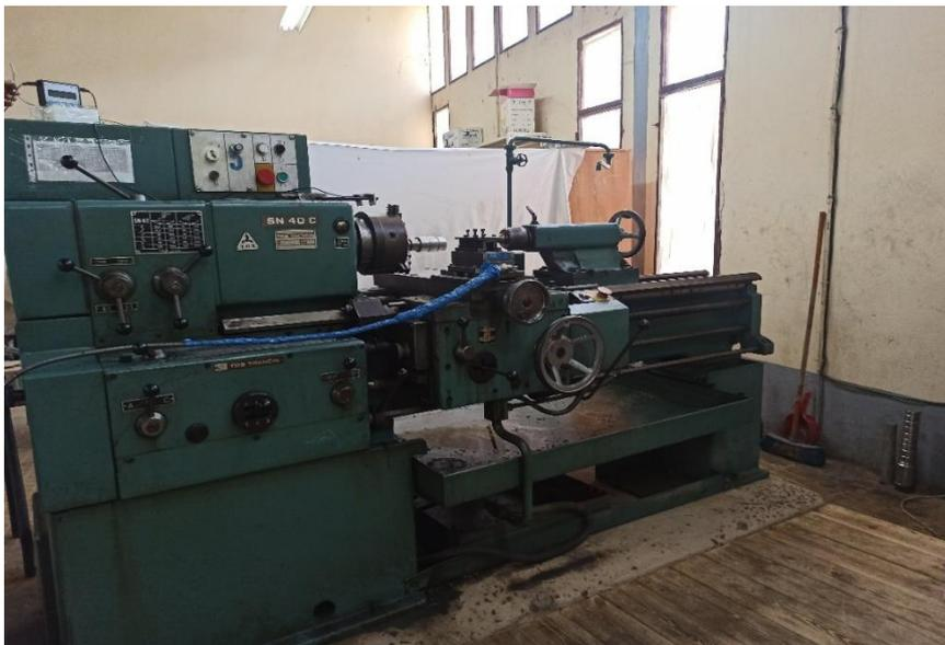
**Figure.II.1** : Tour à charioter et à fileter modèle SN40
