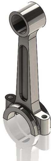
Figure III-10 : Dessin de la bielle sous SolidWorks
