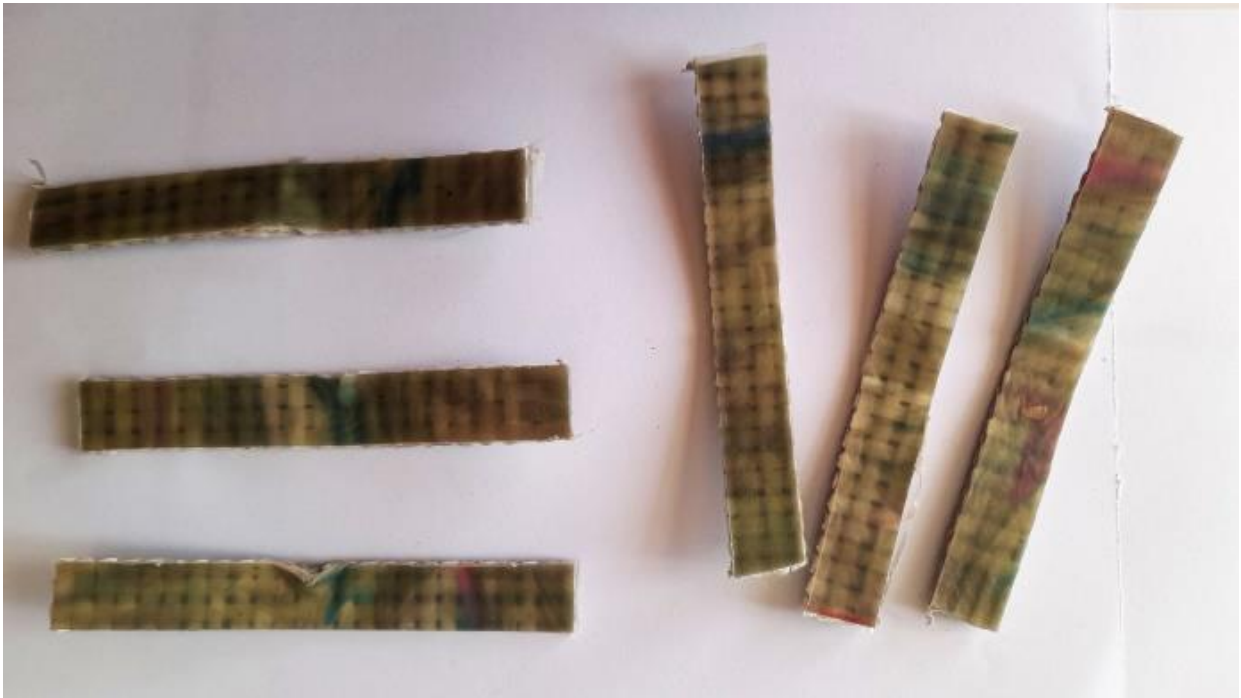
Figure III.17. Faciès de rupture des éprouvettes en composite renforcé par des fibres de verre testées par Charpy.
