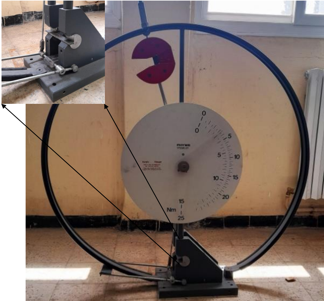
Figure II.13. Equipement pour essai Charpy avec une éprouvette mise en essai.
