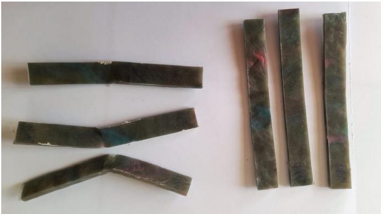
Figure III.16. Faciès de rupture des éprouvettes en plastique testé par Charpy.
