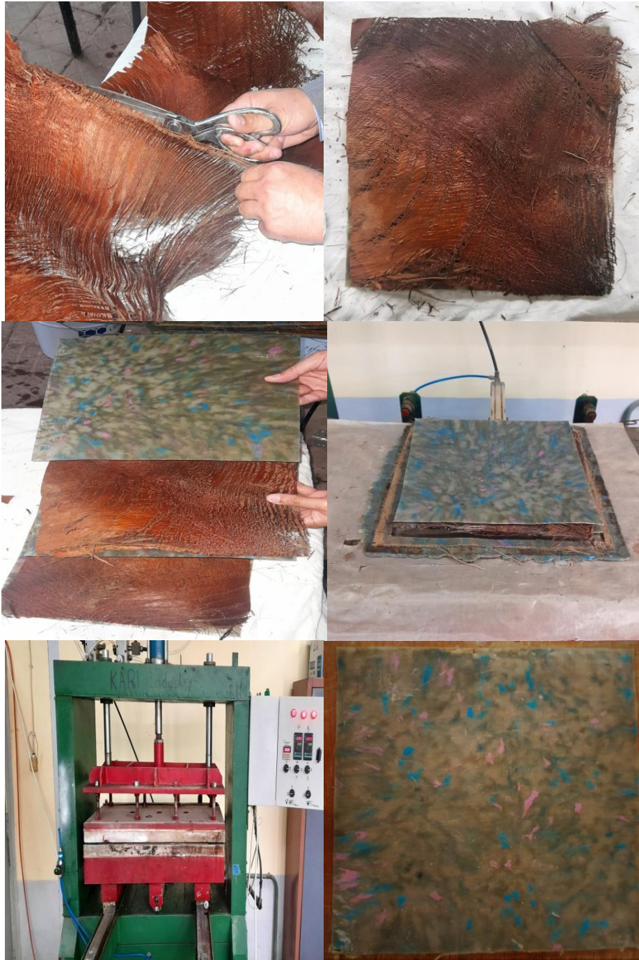
Figure II.8. Préparation des plaques composites renforcées par des fibres de palmier dattier.
