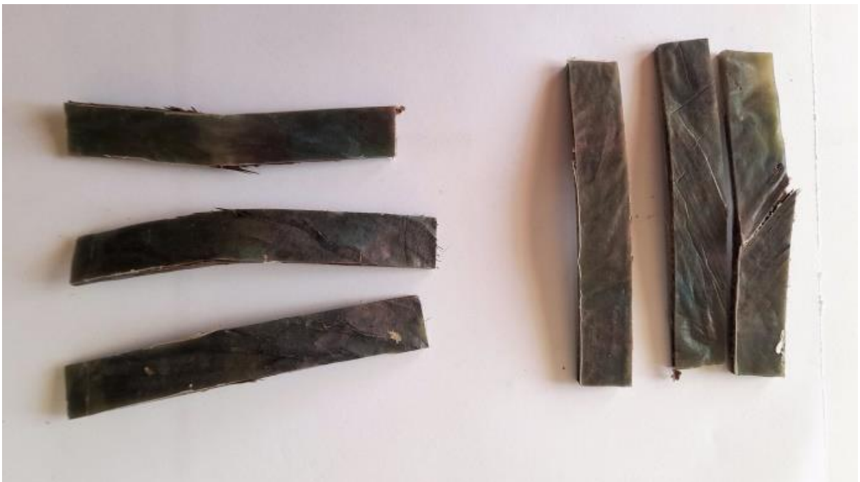
Figure III.18. Faciès de rupture des éprouvettes en composite renforcé par des fibres de palmier testées par Charpy.
