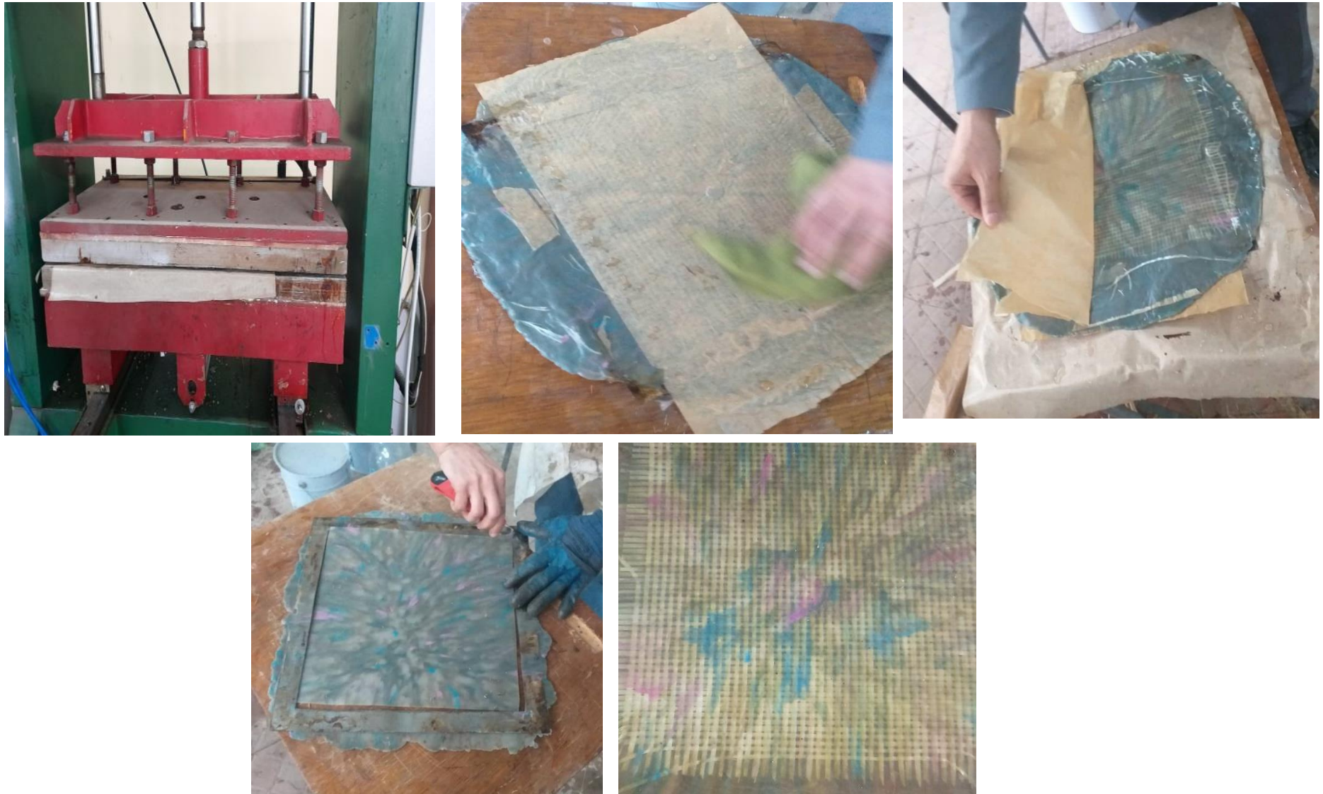
Figure II.7. Préparation des plaques composites renforcées par fibre de verre.
