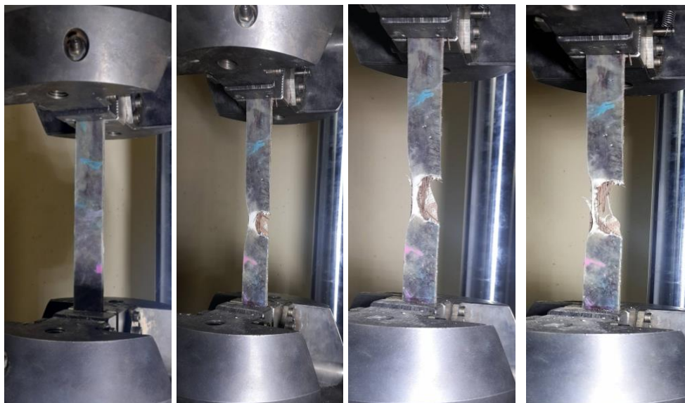
Figure III.10. Faciès de rupture d'un composite renforcé par des fibres de palmier dattier sollicité en traction avec une vitesse de 5 mm/min.
