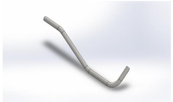
**Figure II.17: tube latéral du cadre scooter ptt cote D**
