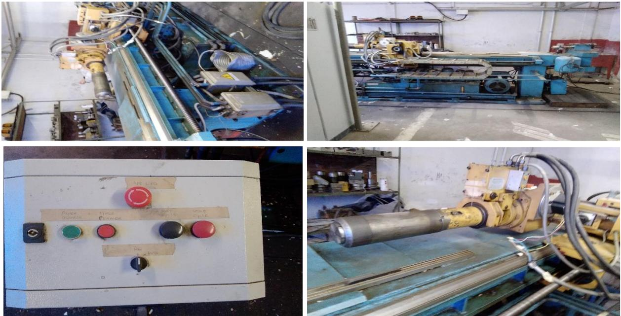
Figure II.1: cintreuse de tubes à commande numérique CRIPPA
