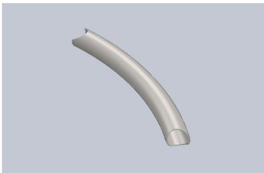
**Figure II.18 : tube latéral de renfort inferieur**
