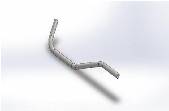
**Figure II.16: tube latéral du cadre scooter ptt cote G**
