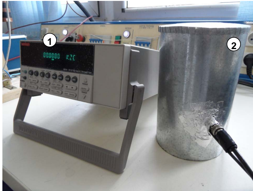
Figure IV.9: Montage de mesure de la charge électrique: (1) Electromètre (Keithley - modèle: 6514), (2) Seau de Faraday.
