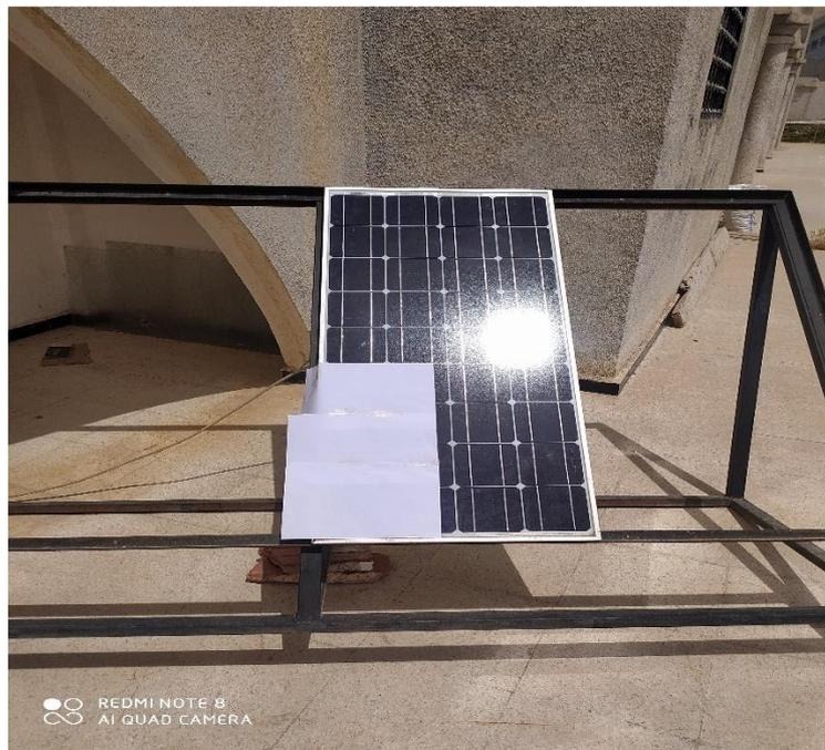
Figure. III. 6 : Défaut d'ombrage partiel 8 cellules en bas-côté gauche.
