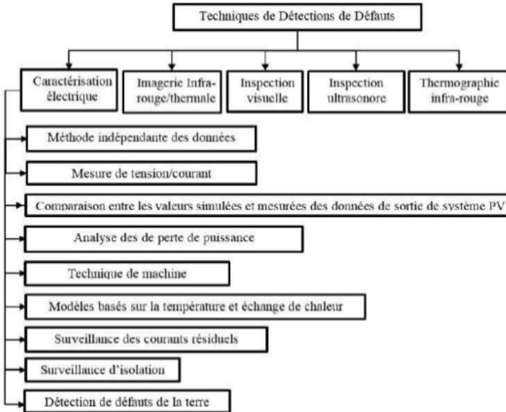
Figure. III. 21 : Techniques de détection de défauts pour les systèmes PV autonomes
