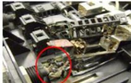
Figure. III. 15 : Exemples de défauts rencontrés dans des boîtes de jonction
