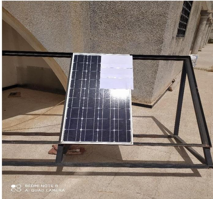
Figure. III. 8 : Défaut d'ombrage partiel de 8 cellules en haut-côté droit.
