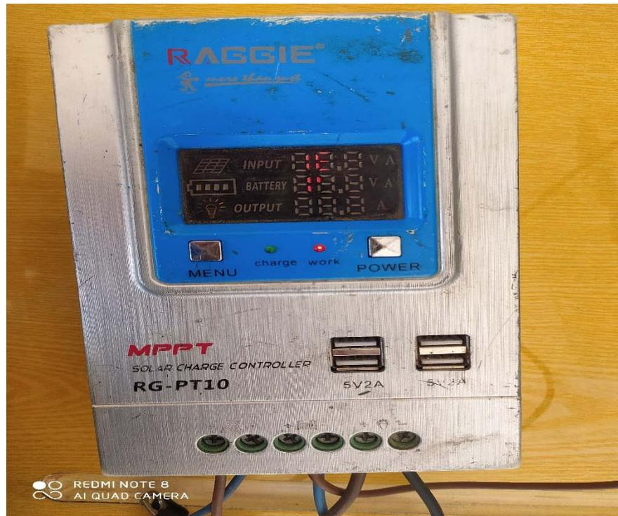
Figure. II. 17 : Régulateur solaire MPPT.
