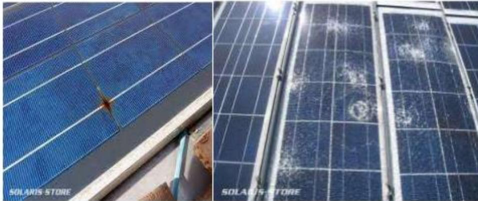
Figure. III. 3 : Fissuration et dommages cellulaires
