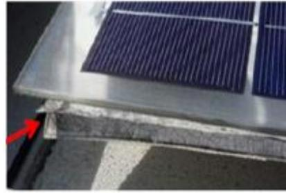
(h) défaut mécanique de la face arrière
