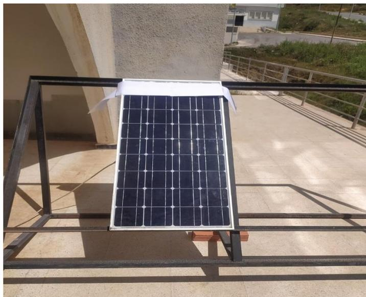
Figure. III. 10 : Défaut d’ombrage partiel de 4 cellules en haut de panneau.
