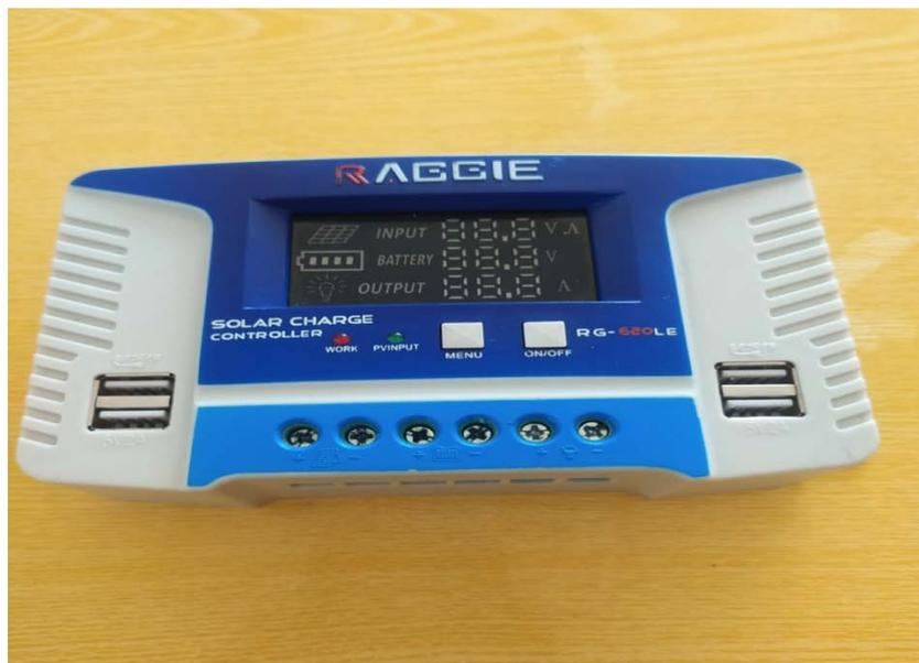
Figure. II. 16 : Régulateur solaire PWM
