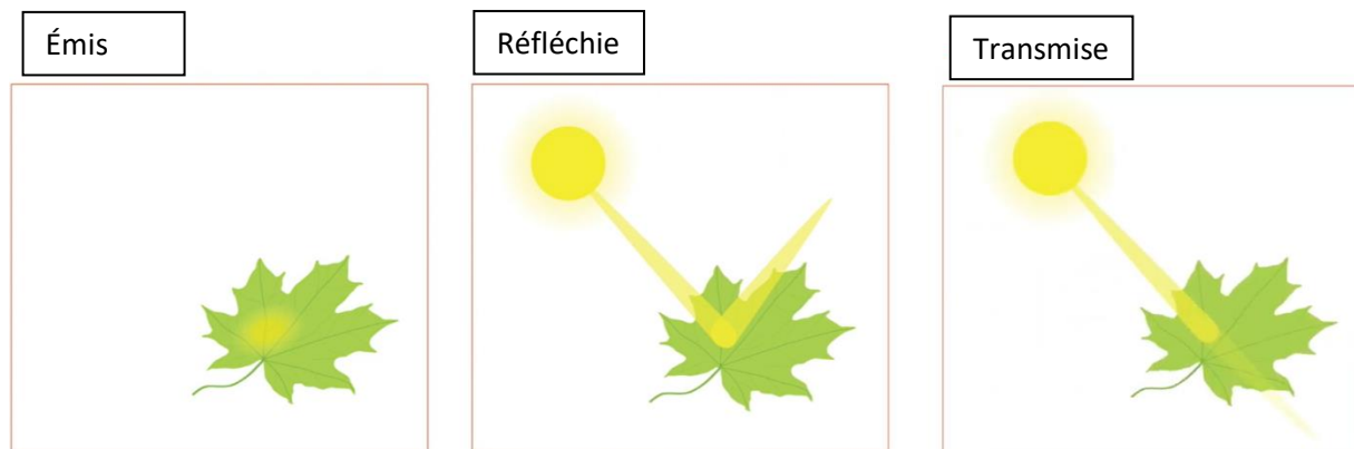
Figure 4 : Spectrum indiquant la quantité de lumière émise, réfléchie ou transmise par la cible
