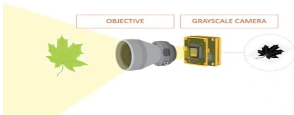
Figure 19 : Projection de l'objectif sur la cible et le capteur de la caméra et l'enregistrement d'image en résultat d'un feuillet noir et blanc.
