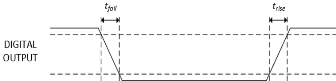
Figure 2.8 : Caractéristiques des entrées-sorties numériques.
