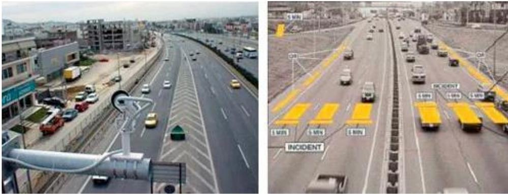
Figure 1.1 : A gauche - image de circulation normale / A droite - une image VIPS avec des zones de détection.
