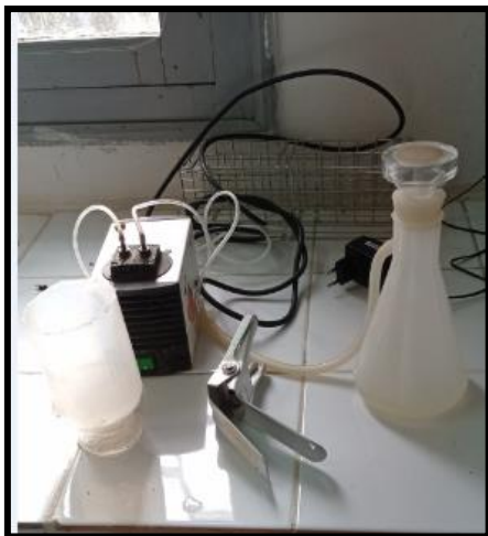
Figure 24 : Ensemble de filtration.
