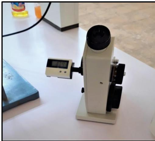
**Figure 05** : Le refractomètre Abbe, utilisé pour la détermination De l'indice de réfraction de l'HE.
