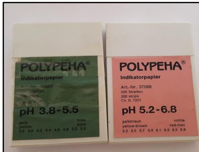
**Figure 06** : Papier indicateur du pH utilisé pour déterminer le pH de l'HE.
