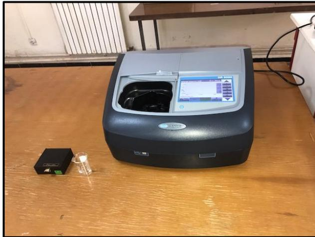
**Figure 09** : Spectromètre HACH LANGE DR6000 utilisé pour l'analyse de L'HE.
