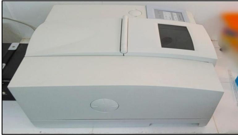
**Figure 08 :** Spectromètre infrarouge utilisé pour l'analyse de l'HE.
