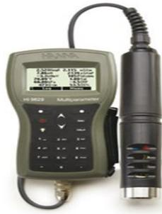
(a) Appareil de mesure des paramètres de la qualité de l'eau de terrain (multi-paramètres)
