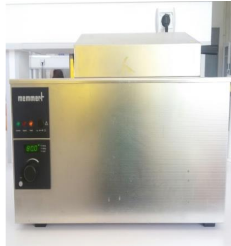
Figure 2 : Chauffage au bain-marie 80°C pendant 30 min (Farjaoui, M'rabti et Touahri,2016)
