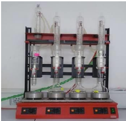
Figure 6 : extraction des lipides avec l'appareil Soxhlet multipostes (behrotest®) (Farjaoui, M'rabti et Touahri,2016)
