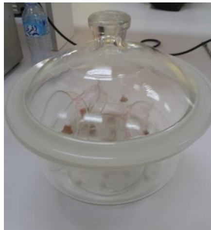
Figure 7 : Refroidissement dans le dessiccateur (Farjaoui, M'rabti et Touahri,2016)
