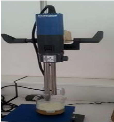
Figure 1 : broyage avec broyeur ( IKA ® T18 basic , ULTRA-TURRAX ® ) , (Farjaoui, M'rabti et Touahri,2016)
