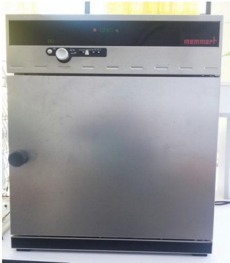
Figure 4 : stérilisation dans Etuve a 105 °C (30 min) (Farjaoui, M'rabti et Touahri,2016)
