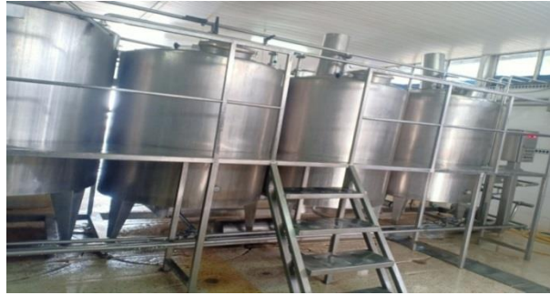
Figure 22. Les cuves de transformation du lait en poudre en lait de sachet (Djafri et al; 2022).
