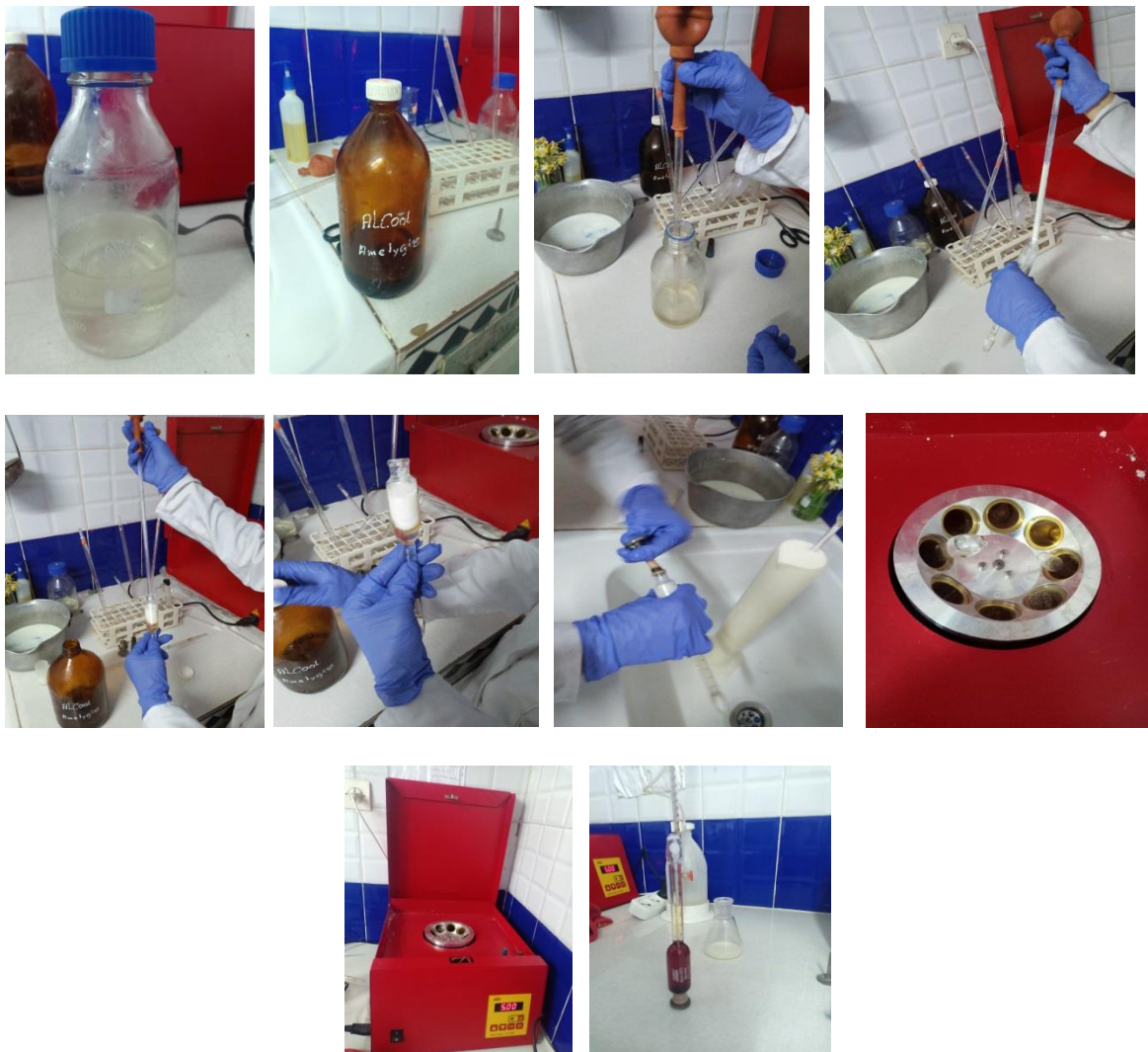
Figure 38. Les étapes de le dosage da la matière grasse du lait par la méthode de gerber (Djafri et al ; 2022).
