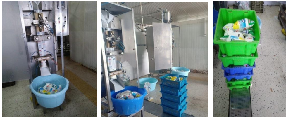
Figure 28. Le conditionnement des produits finis de chaîne de production vers les camions de transport (Chemmakh et al ; 2022).
