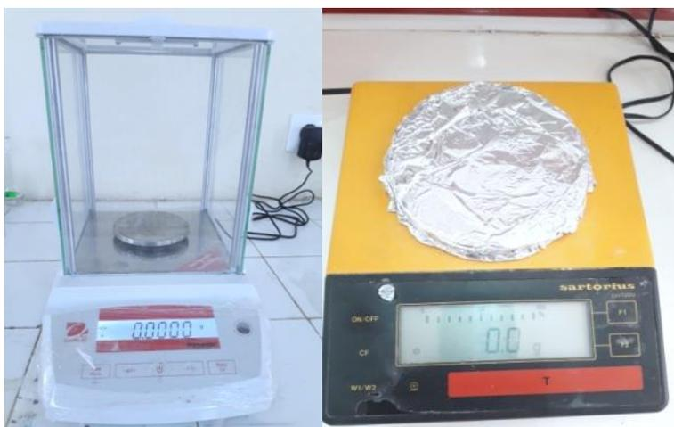
*Figure III. 9: Photos des balances analytique et technique.*
