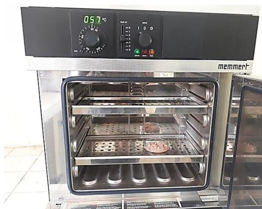
*Figure III. 7: Photo de l'étuve utilisée pour le séchage.*
