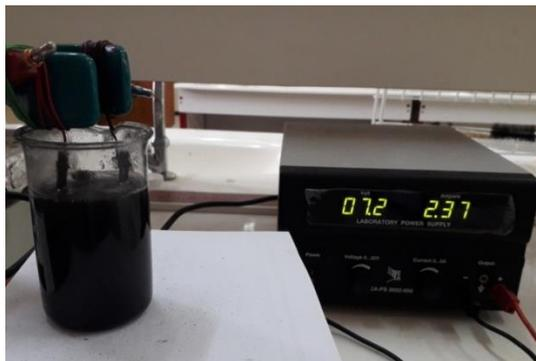
*Figure IV. 2 : Montage de l'exfoliation électrochimique du graphite en milieu alcalin (KOH 1M).*
