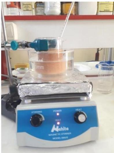
*Figure III. 4: Montage de synthèse chimique de la chitine et du chitosane.*
