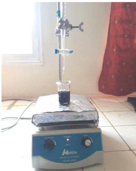
*Figure III. 3: Montage de r duction avec l'hydrazine.*
